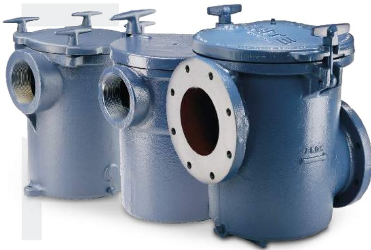
Las resistentes trampas de pelos y pelusas de Pentair están fabricadas en hierro fundido o latón rojo para un servicio de alta resistencia. La succión y descarga de 6 in se adaptan a un rendimiento de alto flujo en una variedad de aplicaciones\*. El patrón de pernos ANSI permite que la instalación y plomería sean más rápidas.
